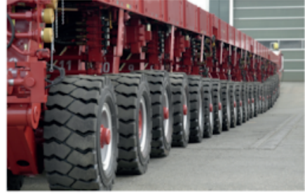
Şekil 2: Artuklu Hamamı'nın taşınmasında kullanılan araçların tekerlekleri
